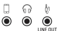
Fiche jack en 3,5mm à utiliser pour l'entrée AUX et les sorties CASQUE symétrique-stéréo et LINE OUT asymétrique-mono.
