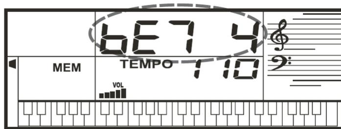
1. Appuyez sur **[FUNCTION]** jusqu'à ce que "bE7 4" apparaisse.
