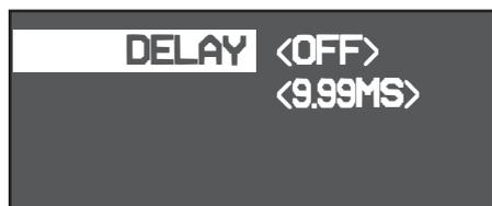
Ce menu permet de restituer le signal entrant avec un retard pouvant aller de 0 jusqu'à 9.99 millisecondes.
