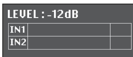
L'écran **LEVEL** indique les niveaux sonores des différentes entrées. Cela vous permet de visualiser le signal et d'ajuster le niveau d'entrée. Une fois le volume augmenté, les niveaux apparaissent, tel qu'affiché ci-dessous :
