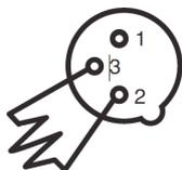
Le bouchon de terminaison réduit les erreurs de signal et évite les problèmes de transmission de signal et les interférences. Il est toujours recommandé de connecter un bouchon DMX (résistance 120 Ohm 1/4 W) entre la broche 2 (DMX-) et la broche 3 (DMX+) de la dernière unité.
